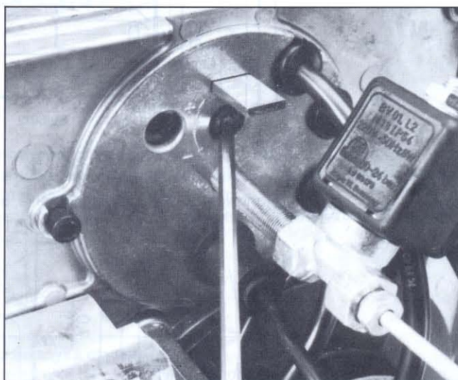
Рис. 5: Настройка вторичного воздуха (перестановка форсунки)
